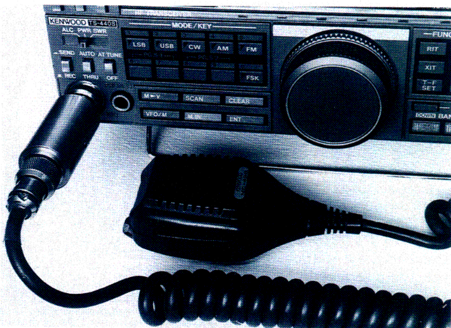
Fig.1. Anjo Eenhoorn, PAoZR, monteerte een schakeling voor een einde-uitzending-toon ("rogerpiep") in een busje dat tussen de stekker en de aansluiting voor de microfoon op zijn TS-440S komt. (Foto: PAoZR.)
